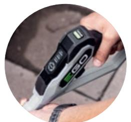
Display für Leistungsanzeige am Griff und an der Maschine.
