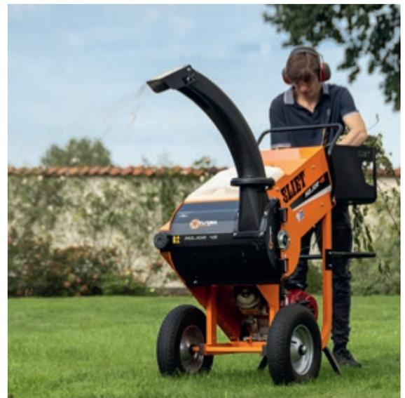
ELIET entwickelte und patentierte ein einzigartiges Häckselsystem, das **Axt-Prinzip™**. Wie bei einer Axt hacken die Messer mit 48.000 Hackbewegungen pro Minute in Faserrichtung. Der Grünabfall wird durch einen Zyklus von Spalten und Schneiden zu kleinen, schnellkompostierenden **Biotech™ Hackschnipsel** verarbeitet.
